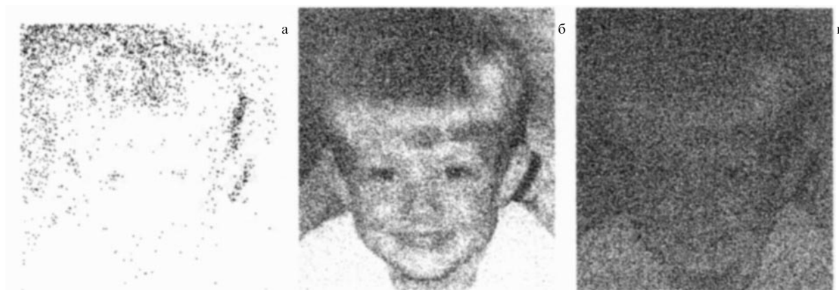
Рис. 20. Картинки на экране дисплея при различном уровне шума, добавленного к подпороговому сигналу.
