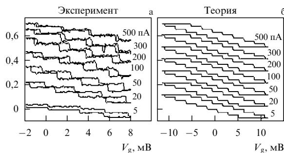
**Рис. 6.** Зависимость ширины петли гистерезиса в одноэлектронной ловушке от тока смещения в считающем электрометре.
