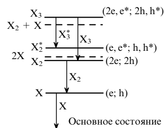
Рис. 4. Схема оптических переходов для многоэкситонных состояний в КТ. Штриховые линии 2X и X_2 + X показывают суммы энергий двух экситонов и биэкситона и экситона соответственно.
