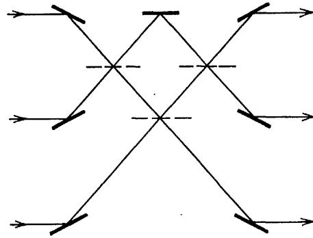
Рис. 10. Система зеркал, перемешивающая три пучка света с фиксированной поляризацией, реализует унитарную группу  $U(3)$
