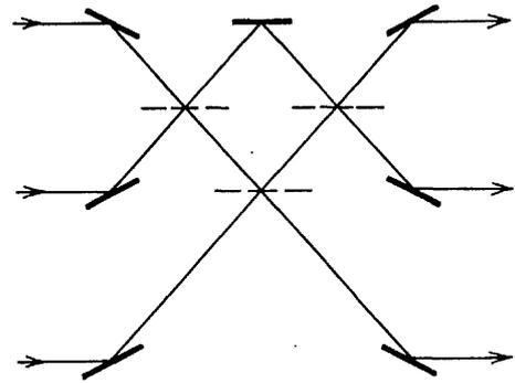
Рис. 10. Система зеркал, перемешивающая три пучка света с фиксированной поляризацией, реализует унитарную группу  $U(3)$
