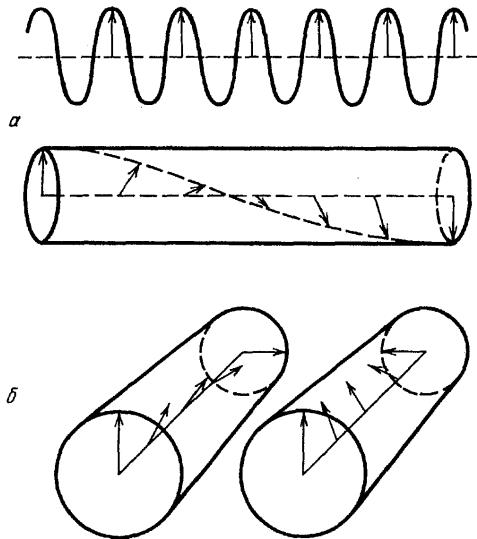
Рис. 3. Возникновение геометрической фазы  $\beta = 180^\circ$  при вращении вектора поляризации  $e$  (стрелки) вокруг направления распространения поперечной волны. Показаны "моментальные снимки" волн. а — Вращение  $e$  на  $180^\circ$ , при этом опорная волна (вверху) не преобразуется. б — Направление  $e$  в обоих плечах интерферометра поворачивается во встречных направлениях на  $\pm 90^\circ$
