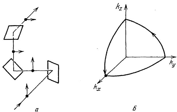
Рис. 2. *a* — Поворот плоскости поляризации пучка света при отражении от трех зеркал: на входе поляризация вертикальная, на выходе горизонтальная. *б* — Отображение изменений направления распространения пучка в пространство волновых векторов  $k_x, k_y, k_z$
