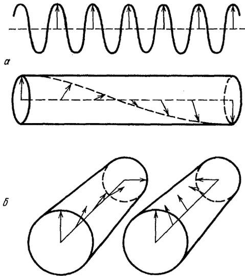
Рис. 3. Возникновение геометрической фазы  $\beta = 180^\circ$  при вращении вектора поляризации  $\mathbf{e}$  (стрелки) вокруг направления распространения поперечной волны. Показаны "моментальные снимки" волн. *a* — Вращение  $\mathbf{e}$  на  $180^\circ$ , при этом опорная волна (вверху) не преобразуется. *b* — Направление  $\mathbf{e}$  в обоих плечах интерферометра поворачивается во встречных направлениях на  $\pm 90^\circ$
