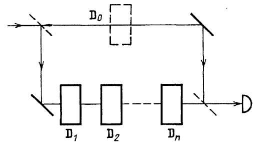
Рис. 4. Схема интерферометра для демонстрации геометрической фазы. Зеркала считаются неполяризующими.  $\mathbf{D}_1, \dots, \mathbf{D}_n$  — трансформаторы поляризации в основном плече,  $\mathbf{D}_0$  — в опорном
