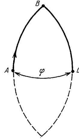
Рис. 9. Путь  $ABC$  на сфере Пуанкаре соответствует действию двух пластин  $\lambda/4$  и дает геометрическую фазу  $\beta = \varphi/2 = \chi + 45^\circ$ , линейно зависящую от угла поворота  $\chi$  второй пластины, причем динамическая фаза  $\alpha$  от  $\chi$  не зависит. Пунктир — возможный замыкающий путь для  $ABC$
