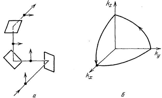
Рис. 2. *a* — Поворот плоскости поляризации пучка света при отражении от трех зеркал: на входе поляризация вертикальная, на выходе горизонтальная. *б* — Отображение изменений направления распространения пучка в пространстве волновых векторов  $k_x, k_y, k_z$
