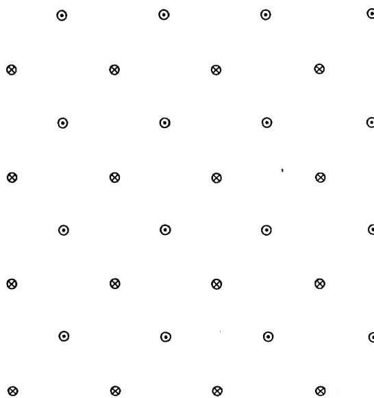
Рис. 1. Кубическая объемноцентрированная решетка. Кружки с точкой в середине отмечают места молекул одного слоя, кружки с крестиком соответствуют положению молекул другого слоя. Далее слои чередуются. Расстояние между соседними слоями равно a/\sqrt{3} , сторона квадрата слоя равна 2a/\sqrt{3}
