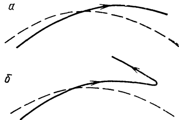
Рис. 1. Лучевые траектории альвеновской волны (а) и свистящего атмосферика (б). Штрихами показаны силовые линии магнитного поля
