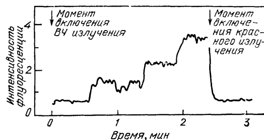
Рис. 28 Ступенчатое увеличение интенсивности резонансной флуоресценции Ba^+ при инъекции 1-го 2-го 3-го и 4-го ионов в ловушку. При отключении красного излучения ( \omega ) ионы переходят в метастабильное состояние ^2D_{3/2} (из [60])
