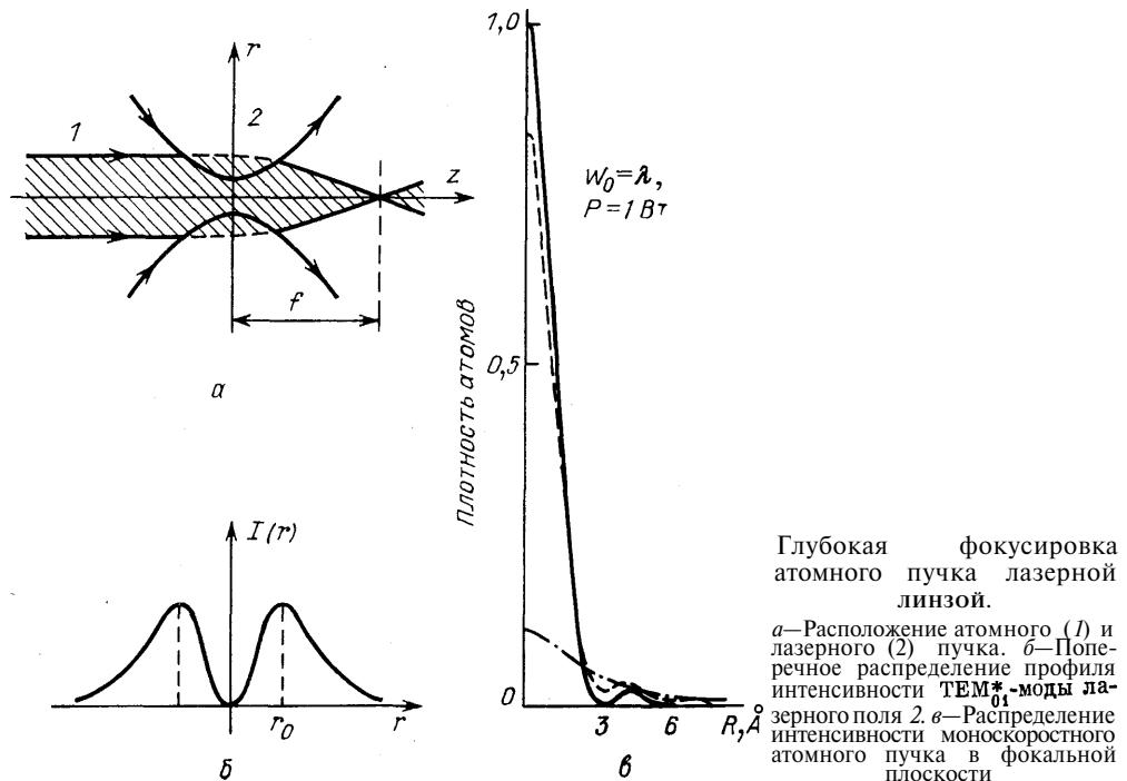
На рис. 1, *в* распределение рассчитано при следующих параметрах:  $P = 1$  Вт,  $v_{\text{ат}} = 2,2 \cdot 10^5$  см/с,  $\Delta v_{\text{ат}}/v_{\text{ат}} = 10^{-3}$ . Диаметр атомного объектива равен  $\lambda$ . Из расчета следует, что все распределения близки к дифракционным.
