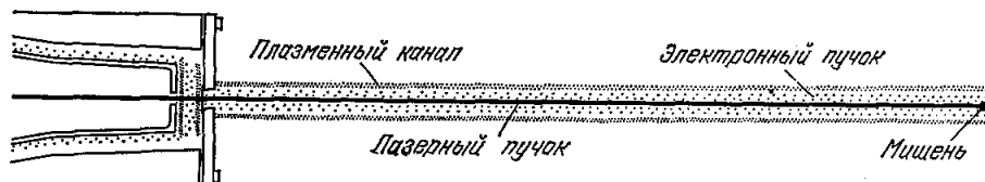
Рис. 8. Распространение пучка электронов в заполненной воздухом рабочей камере термоядерного реактора будет обеспечено созданием канала замагниченной плотной плазмы, по которому сфокусированный электронный пучок сможет транспортироваться от выходного конца изолированной вакуумной линии до мишени термоядерного топлива, установленной в центре камеры.
