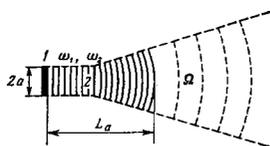
FIG. 1. Scheme of a parametric antenna.
