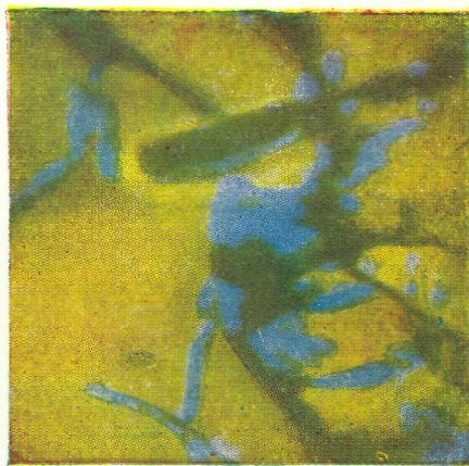
Рис. 6. Катодолюминесцентное изобра- жение зональности замещения молибдо- шеелита шеелитом и молибденитом. Увеличение 1000×.
