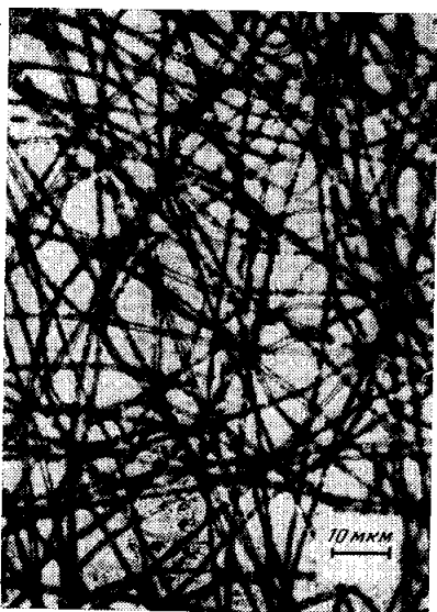
Рис. 12. Структура волокнистых фильтров Петрянова 18 .
