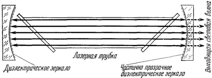
Рис. 7. В гелий-неоновом лазере используются диэлектрические зеркала. Только зеркала такого типа могут иметь коэффициент отражения, близкий к 100%, который необходим для работы с коэффициентом усиления около 1%.
