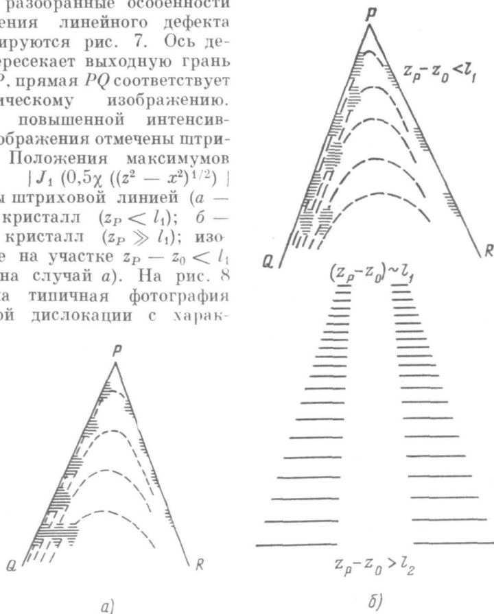
Рис. 7. Схема изображения прямолинейного дефекта, построенная с помощью функций влияния.
