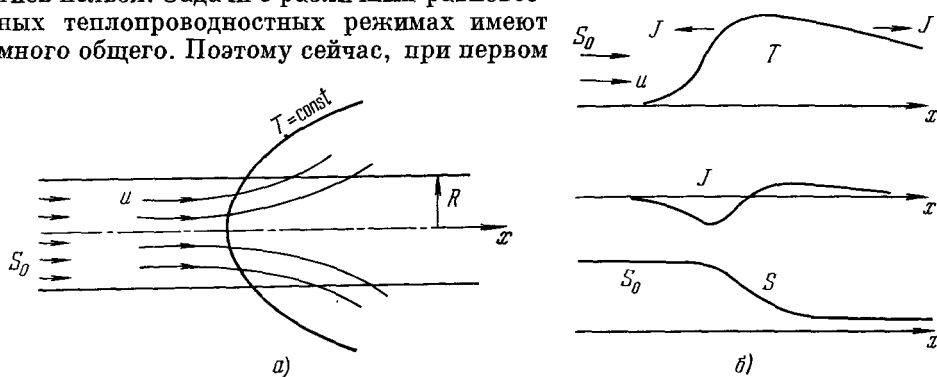
Рис. 4. а) Схематическая картина растекания тепла и расширения газа (показаны линии тока и изотерма); б) схематические профили температуры, потока тепла и потока электромагнитной энергии в режиме с потерями.
