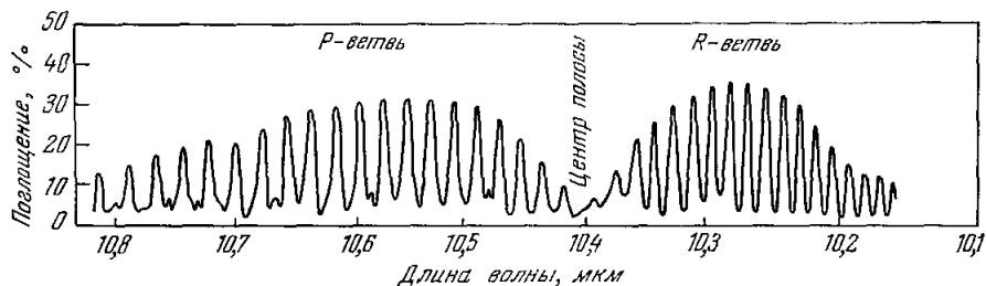
Рис. 3. Переходы между вращательными подуровнями энергии, принадлежащими двум различным колебательным уровням одного и того же электронного состояния молекулы двуокиси углерода, приводят к инфракрасному излучению ряда различных длин волн, образующих так называемую колебательно-вращательную полосу. На кривой показаны длины волн линий поглощения невозбужденного углекислого газа. Центр полосы соответствует интервалу между колебательными уровнями в отсутствие энергии вращения; переходы с длинноволновой стороны соответствуют изменению углового момента вращения на +h/2\pi и образуют P -ветвь, тогда как коротковолновые переходы происходят с изменением момента на -h/2\pi и образуют R -ветвь. Приведенная на рисунке полоса дает лазерное излучение 10,6 мкм.
