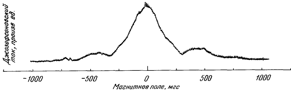
Рис. 9. Зависимость джозефсоновского тока от магнитного поля для двух параллельно соединенных барьеров, демонстрирующая интерференционные эффекты 37 . Интерференционные максимумы отстоят друг от друга на \Delta H = 4,8 \cdot 10^{-3} эс. Максимальный джозефсоновский ток соответствует примерно 10^{-3} а.
