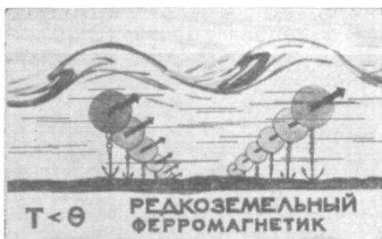
Рис. 6. Наглядная картина ферромагнитного порядка в f -металлах с косвенным обменным взаимодействием f -оболочек через электроны проводимости
