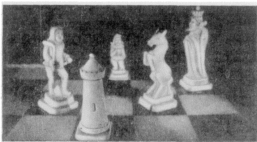
Рис. 3. Восстановленное изображение было получено при освещении голограммы лучом лазера.
