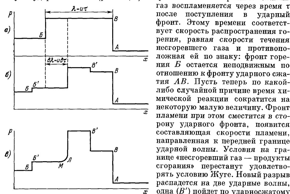
Рис. 16. Возникновение двух ударных волн B' и B' при сокращении периода задержки воспламенения во фронте детонации на \delta\tau .
