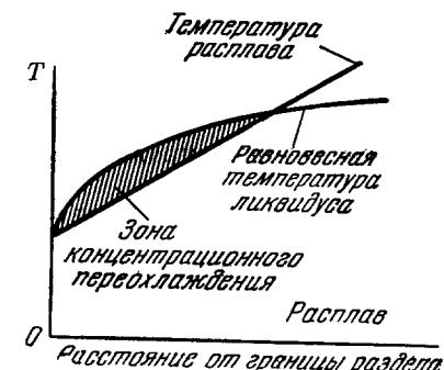
Рис. 7. Зона концентрационного переохлаждения в расплаве перед движущейся границей раздела кристалл — расплав.
