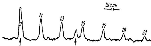
Рис. 2 Вращательный спектр комбинационного рассеяния газообразного кислорода при давлении 3 ат. Стрелками отмечены «дұхи» решетки.
