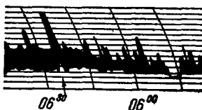
Рис. 26. Записи амплитуды радиоволн, принятых в результате рассеяния от следов 1-го спутника и метеорных следов.
