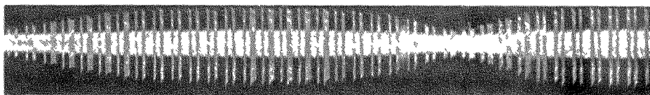
Рис 9 Образец записи амплитудной модуляции радиосигналов 3-го спутника, обусловленной вращением Фарадея, Москва, 1958 г
