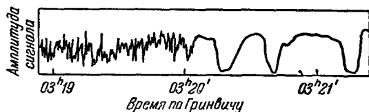
Рис. 14. Образец записи амплитуды сигналов 1-го спутника в частоте 40 мегц в Кембридже; по таким записям исследовалась мелкомасштабная неоднородность ионосферы типа F2_{\text{спор}} .
