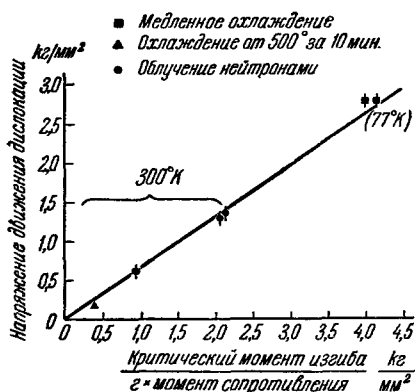
Рис. 11. График зависимости напряжения движения свежей дислокации от прочности кристалла.
