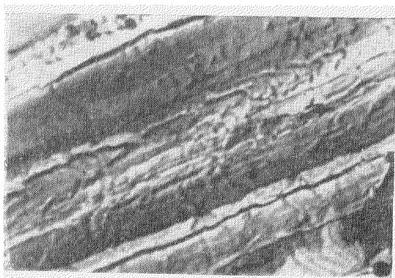
Рис. 14. Следы полос базисного скольжения монокристалла бериллия (99,7%) (Гарбер, Гиндин, Ковалев, Шубин 118 ). Сжатие на 4,7% при 400^\circ\text{C} . Микротрещины локализованы вдоль полос скольжения \times 10000 .
