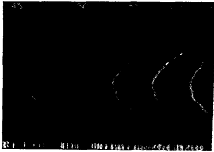
Рис. 38. Полосы равного хроматического порядка для видимой области спектра, полученные с помощью установки для наблюдения колец Ньютона (ср. рис. 36).
