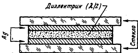
Рис. 75. Схема интерференционного светофильтра.
