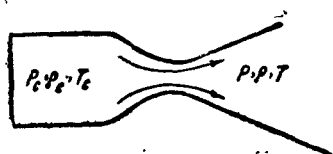
Рис. 2. Термодинамические параметры в камере сгорания и в произвольном поперечном сечении сопла.
