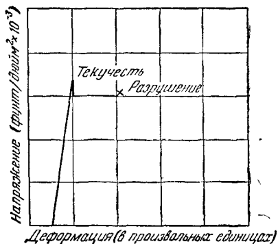
Рис. 4. Понижение разрушающего напряжения благодаря начальной деформации (перлитная сталь при -190^{\circ}\text{C} ).
