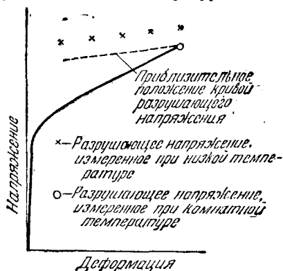
Рис. 2. Метод нахождения кривой действительного разрушающего напряжения.
