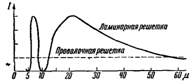
Рис. 29. Приблизительный ход кривой интенсивности I в спектре первого порядка у ламинарной решетки ( h = 5 \mu ) — и у проволочной решетки -----
