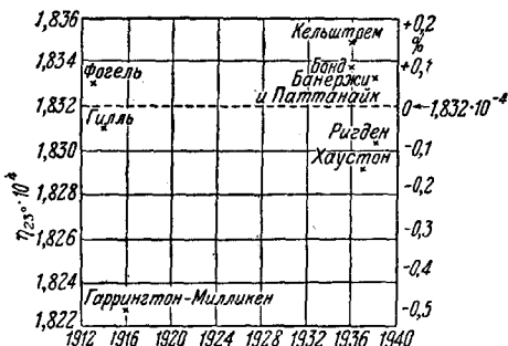
Рис. 1. Старые и новые измерения коэффициента вязкости воздуха
