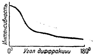
Рис. 5. Экспериментальные кривые интенсивности в зависимости от угла дифракции, в случае жидкостей.
