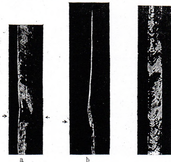
Рис. 5, a и b показывают растянутую однокристалльную проволочку цинка: a перпендикулярно к широкой стороне ленты, b параллельно ей. Снизу до стрелки кристалл остается нерастянутым, и первоначальная приблизительно цилиндрическая форма не изменена. Начиная отсюда вверх ширина ленты несколько превосходит толщину исходной проволочки. На рис. 5, c показана еще одна растянутая цинковая проволочка с хорошо видимыми линиями скольжения, причем последние явственно отклоняются от средней линии ленты.
