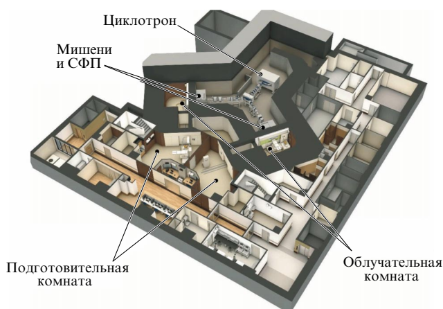
Рис. 8. Схема центра БНЗТ на базе циклотрона NM-30 в больнице Южного Тохоку.
