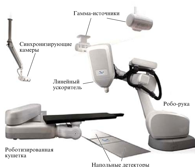
Рис. 12. Оборудование "кибер-ножа" в лечебной комнате.
