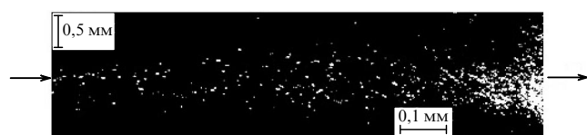
Рис. 11. Центры рассеяния ("блёстки"), возникающие в кристалле \text{LiNbO}_3 при прохождении через него лазерного излучения. Стрелками помечены вход в кристалл и выход лазерного луча из кристалла. Фотография публикуется впервые.
