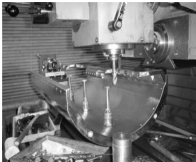
Рис. 19. Монтаж ускоряющих электродов непосредственно на станке.
