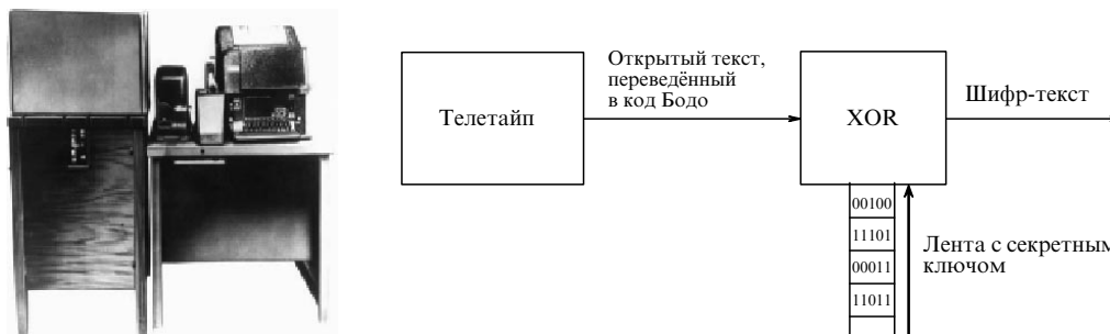
Рис. 2. Полиалфавитный телетайп Вернама с "бегущими ключами". Хранится в Агентстве национальной безопасности США [22].
