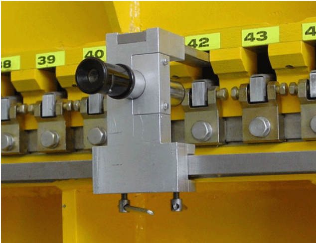
Рис. 9. Система настройки положения осей магнитных катушек для достижения прямолинейности магнитного поля на уровне лучше 10^{-5} .
