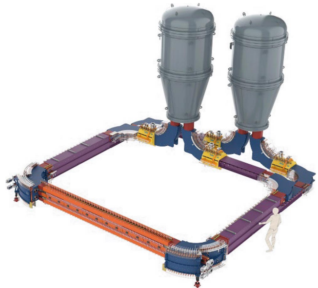
Рис. 19. СЭО Коллайдера имеет два участка охлаждения с электронными пучками, движущимися в прямолинейных секциях навстречу друг другу, для охлаждения ионных пучков в коллайдере NICA в верхнем и нижнем кольцах.
