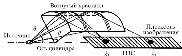
Рис. 17. Спектрограф Гамоща с детектором (ПЗС-линейкой) на оси цилиндра [44].
