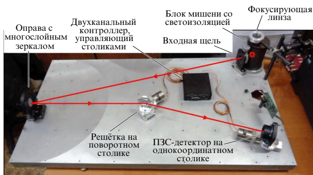
Рис. 34. Широкополосный изображающий спектрограф с разрешением 26 мкм (Mo/Si: 12,5–30 нм, Mo/Ве: 11–14 нм; \lambda/\delta\lambda \sim 1000 ). Зеркало Mo/Ве синтезировано в ИФМ РАН [86–90].
