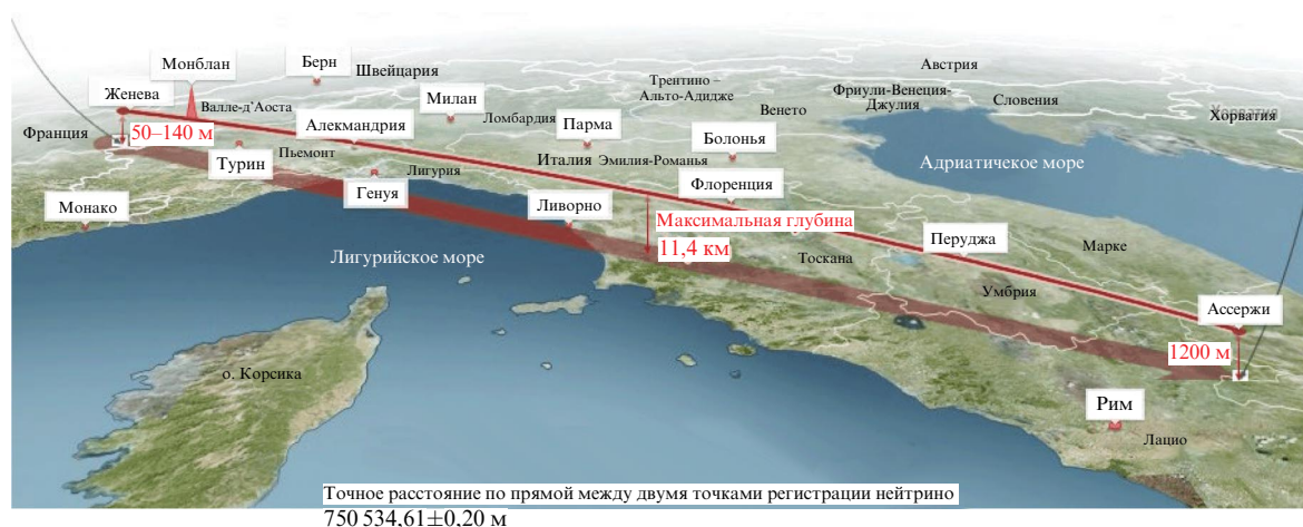
Рис. 8. Схема прохождения пучка нейтрино от ЦЕРН до LNGS.
