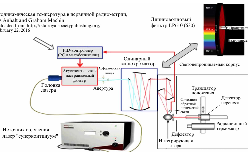
Рис. 4. Схема установки для градуировки радиационного термометра с использованием лазера "суперконтинуум" для целей радиационной термометрии.
