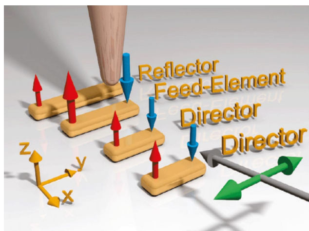
Рис. 29. Схема эксперимента [351]. Антенна "волновой канал" (Yagi-Uda), сфабрикованная золотом на стекле. На структуру направлен расфокусированный луч лазера ( \lambda = 1,064 мкм) в s-поляризации (зелёные стрелки параллельно поверхности) под скользящим углом (серая стрелка, направлена справа на структуру). Компоненты ближних полей, нормальные к поверхности (вертикальные красные и синие стрелки) могут связаться с острой иглой и с её помощью быть рассеяны в дальнее поле.
