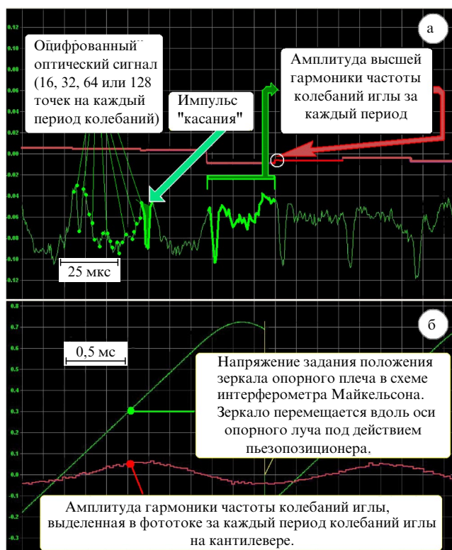
Рис. 7. Виртуальный осциллограф программы выделения компоненты ASNOM в сигнале с фотодетектора. (а) Выделение сигнала высшей гармоники в пределах одного периода колебаний иглы. (б) Записанные таким образом данные образуют при пилообразном законе движения зеркала синусоиду, параметры которой следует определить фитом [144].
