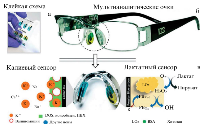
Рис. 22. (а) Фотография сменных наклеек с датчиками. (б) Фотография биосенсорной системы очков, интегрированной с беспроводной печатной платой вдоль дужек. (в) Электрохимические датчики, располагаемые на носоупоре, со схемой датчика калия (слева) и датчика лактата или глюкозы (справа), а также этапы распознавания соответствующих метаболитов [114]. BSA — бычий сывороточный альбумин, LOx — лактатоксидаза.
