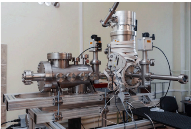
Лабораторная установка для изучения криогенных поверхностных процессов в Самарском филиале ФИАН. Ориентирована на изучение механизмов роста органических соединений в условиях межзвёздных льдов.
