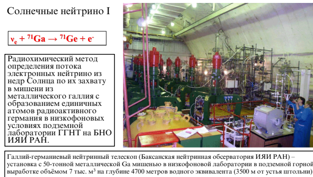
Рис. 24. Экспериментальный зал и реакторы галлий-германиевого нейтринного телескопа в подземной лаборатории БНО ИЯИ РАН.
