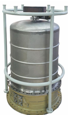
Рис. 6. (а) Водородный мазер, установленный на борту космического телескопа "Радиоастрон". (б) Аллановская девиация частоты мазера за вычетом линейного дрейфа. Для записи данных на борту использовались интервалы около 1000 с, что соответствует относительной погрешности частоты 10^{-15} .
