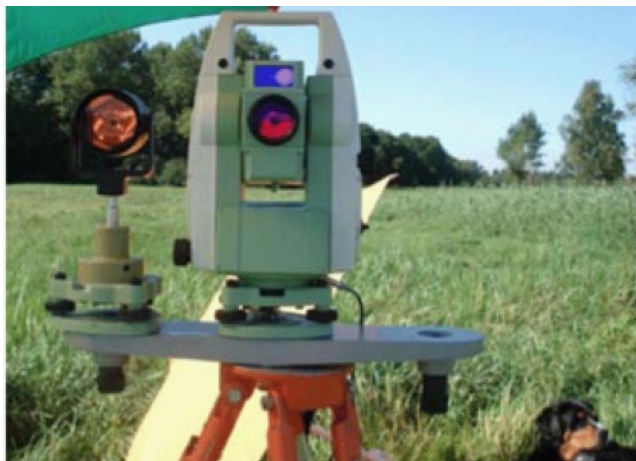
Рис. 5. Роботизированный электронный тахеометр Leica TCRP1201 с угловым отражателем, установленным на горизонтальной пластине на высоте инструмента [69].
