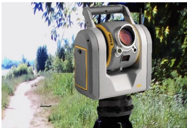
Рис. 13. (В цвете онлайн.) Роботизированный электронный тахеометр Trimble SX10, установленный на трассе, проходящей параллельно Сходненскому каналу (на рисунке расположенном слева от трассы) [98].
