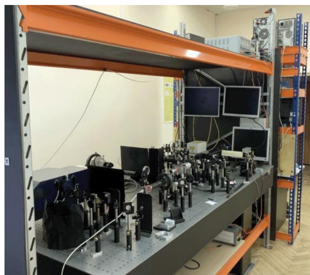
Рис. 5. Фотография установки для лазерного нагрева веществ в ячейках высокого давления.
