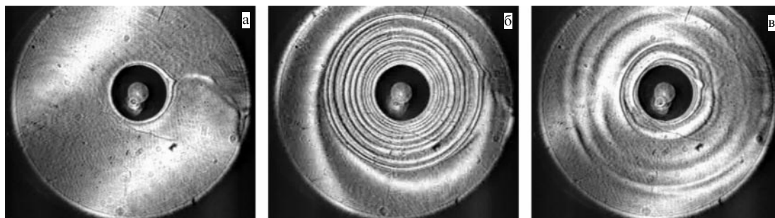
Рис. 2. Эволюция возмущения поля концентрации вокруг пузырька воздуха в горизонтальном слое водного раствора изопропилового спирта. Толщина слоя h = 2,6 мм, перепад концентрации \Delta C = 20 %, диаметр пузырька d = 5,0 мм. Вид сверху: (а) t = 0 , (б) t = 2,0 с, (в) t = 10,0 с.
