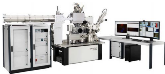
Рис. 30. Внешний вид кластерного TOF-SIMS-микроанализатора J105 3D Chemical Imager (Ionoptika, Великобритания) [286].
